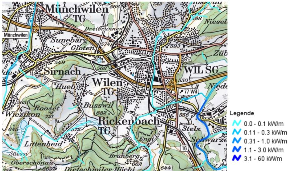
Abbildung 9: Kleinwasserkraftpotenzial (Quelle: Kleinwasserkraftpotentiale der Schweizer Gewässer (Bundesamt für Energie, <http://map.geo.admin.ch>))
