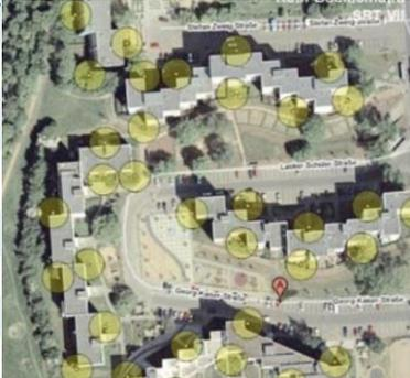
Abbildung 8: Exemplarische Darstellung Erdsondendichte (BBSR 2015)
